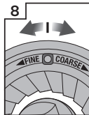
Verstellbaren oberen Teil des Mahlwerks mit der Nummer 1 gröber oder feiner einstellen
